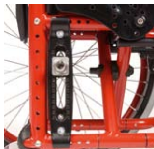
Palier de roues arrière optimisé
